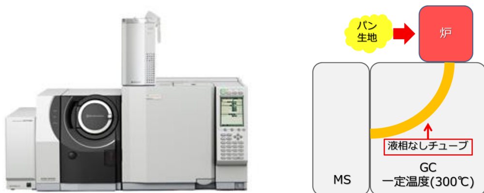
図. 熱分解 GC-MS システムと模式図
